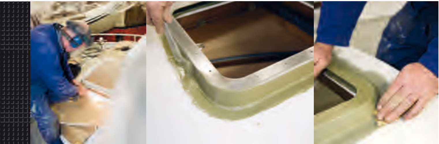
Met een haakse slijper maken we de las glad.
