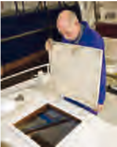
Het oude voorluik wordt verwijderd. Het originele luikhoofd blijft staan en draagt zo bij aan de stijfheid van het dak.
