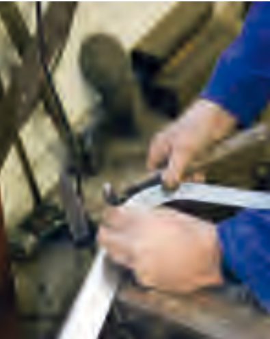
De boutgaten van het nieuwe luik zetten we over op het luikhoofd. Hier worden de posities van de gaten gemarkeerd met een centerpunt.
