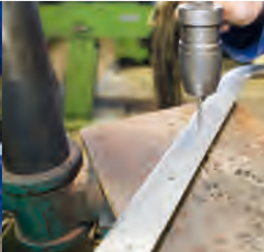
De gaatjes van de centerpunt zorgen ervoor dat de kolomboor op exact het goede punt start met boren.
